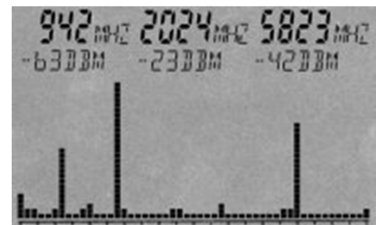
デジタル画面上のRFスペクトル表示と自動トリプルマルチマーカ表示
