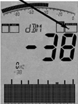
RFパワーメータ・モードによる測定
